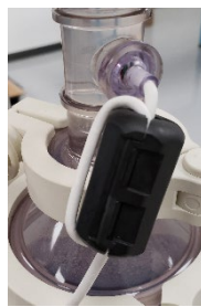
Figura 3. Núcleo de ferrita instalado en el sensor de presión de la ruta del flujo
