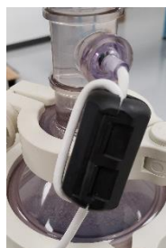
Figure 3. Installeret ferritperle på strømingsvejstrykføler
